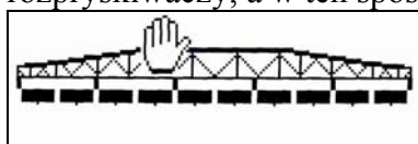
Rys. 4-18: Sekcje; przełącznik główny wyłączony; wybrano wszystkie sekcje
