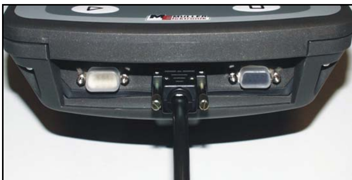
Rys. -9: BASIC-Terminal z podłączonym kablem do wyposażenia podstawowego
