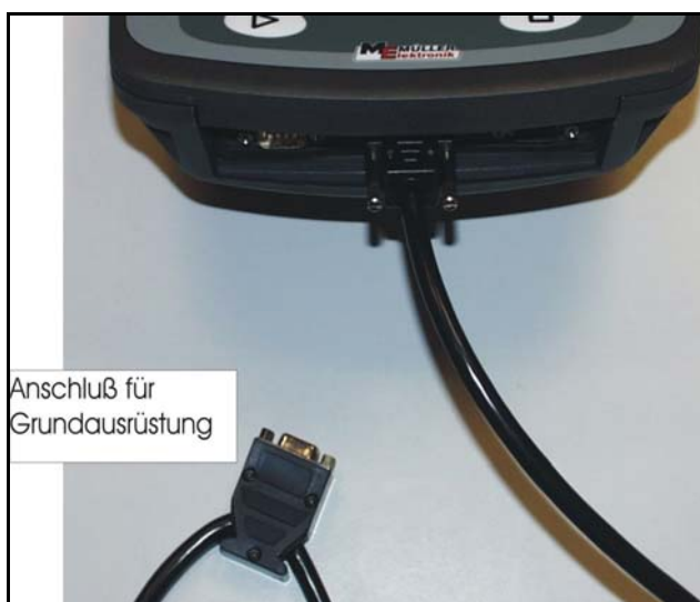
Rys. -10: BASIC-Terminal z kablem podłączeniowym uchwyty wielofunkcyjnego i przyłączem do wyposażenia podstawowego
